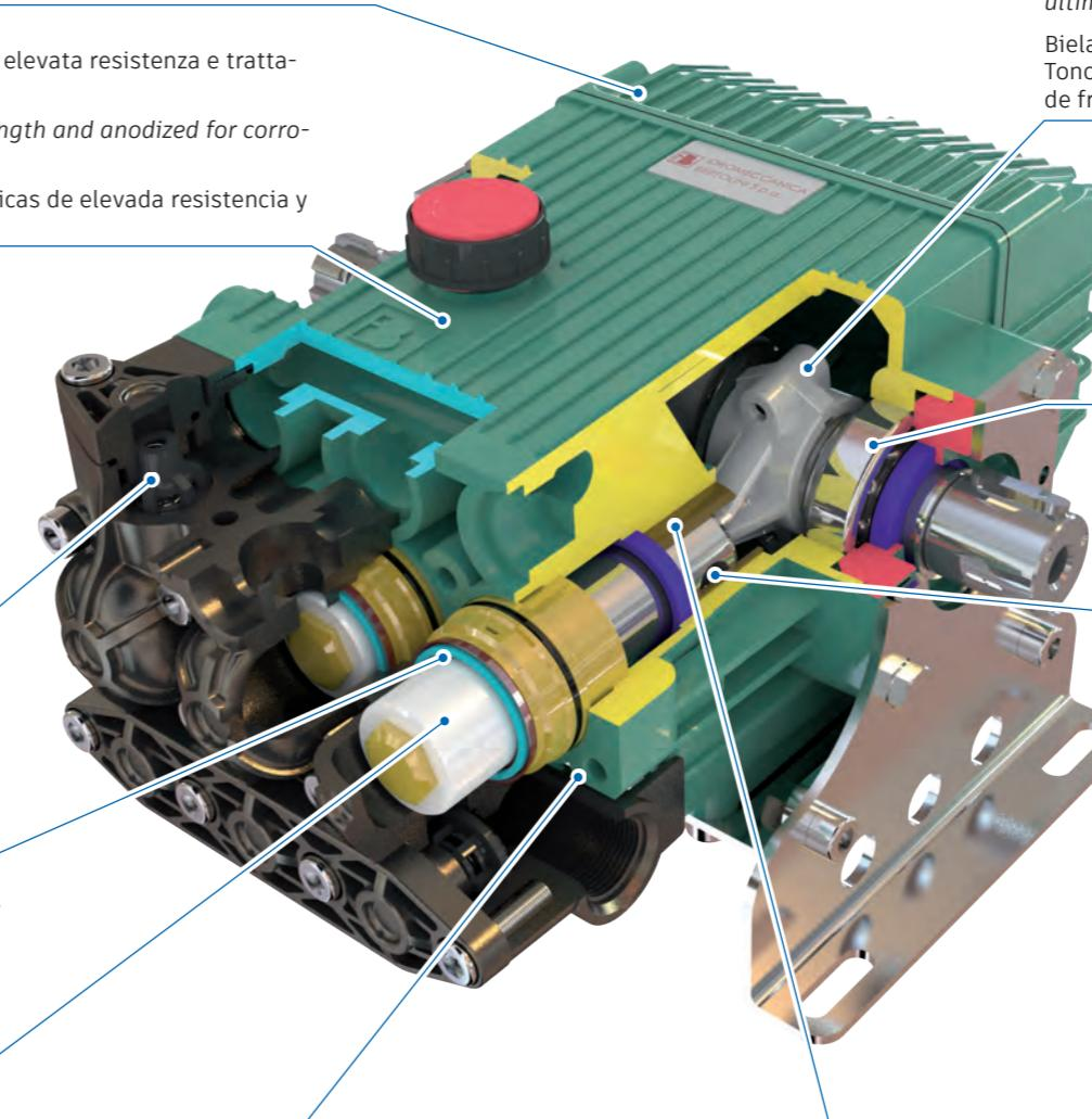
Biella in due parti autocentranti sull'eccentrico in lega Tonolli 328 o in lega di bronzo. Riduce definitivamente l'effetto frizione e l'usura per riscaldamento.
