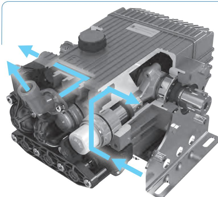
Le pompe serie C53 e C75 sono dotate di un esclusivo e brevettato sistema di raffreddamento del carter. Il condotto di mandata ricavato nel carter fa sì che l'olio in esso contenuto venga fortemente raffreddato dal passaggio dell'acqua pompata.
