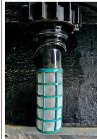
La cartuccia del filtro nella foto è stata rimossa per la prima volta, dopo aver lavorato in modalità autopulente, per 5 anni ed aver filtrato i liquidi da trattamento, utilizzati per coprire una superficie di 8000 ettari!
