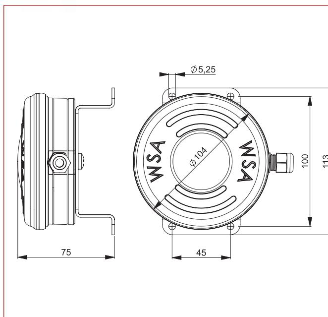
**Sensore induttivo di velocità e di giri:**
