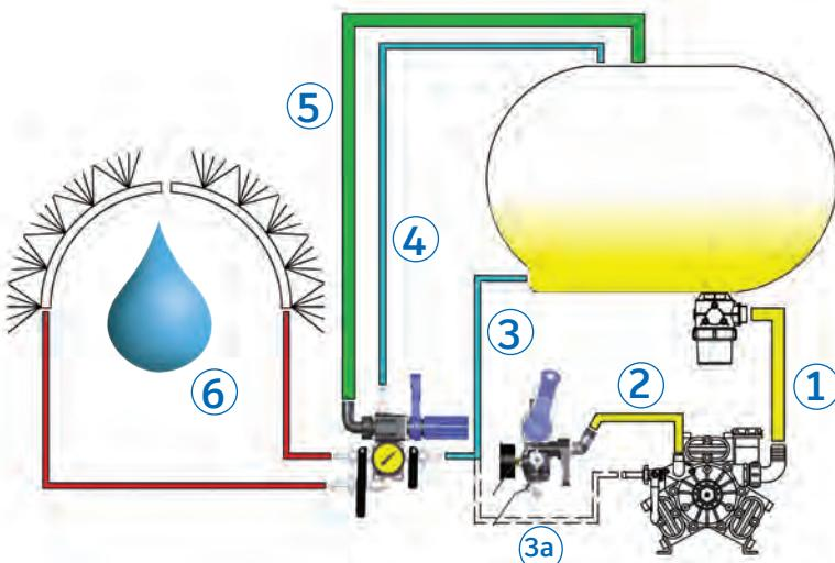
**ANTIGOCCIA:** La valvola è dotata di un sistema Antigoccia automatico integrato, che interviene ogni volta che la valvola è in by-pass.
