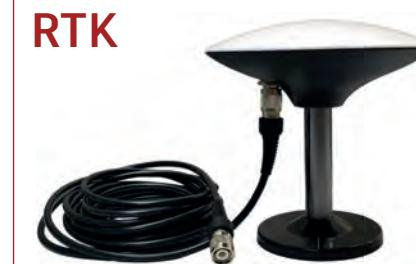
RTK è l'antenna per le attività che richiedono una precisione assoluta. Oltre all'ottima precisione standard, infatti, l'antenna esterna ed il ricevitore integrato, elaborano i segnali GNSS e possono utilizzare la correzione differenziale terrestre RTK\* per fornire dati di posizionamento ad altissima precisione con una frequenza di aggiornamento di 10Hz.
