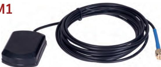
SM1 è un'antenna basilare, economica ma precisa, di piccole dimensioni, per adattarla con facilità ai piccoli irroratori e a fertilizzatori. L'antenna è dotata di ricevitore dual band per elaborare segnali GPS, GLONASS e SBAS. Fornisce dati di posizione con una precisione di +/- 40 cm, ad una frequenza di aggiornamento di 10Hz.
